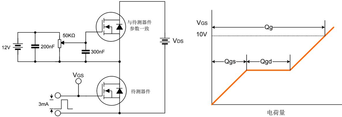
开关时间测试电路及波形图
